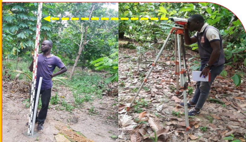
Figure 3. Mesure du niveau d'un piézomètre à l'aide d'un niveau de chantier pour déterminer les différences de niveau avec les autres équipements de mesure du site. © Alassane Traoré
