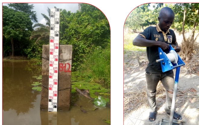
Figure 2. Mesure du niveau d'eau dans un piézomètre par le propriétaire de l'étang (à droite). Limnimètre installé sur le moine pour la lecture du niveau d'eau (à gauche). © Alassane Traoré
